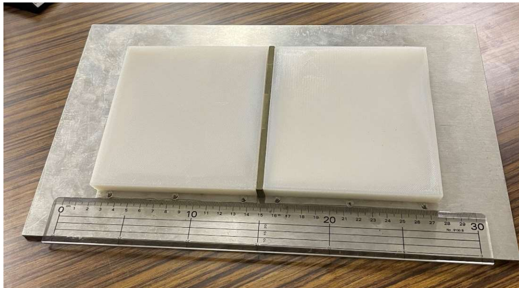
試作 アンテナ (W=130mm X=126.5mm)
